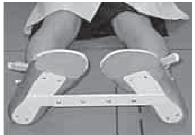
図1 大腿骨近位部の骨密度測定用下肢固定具
